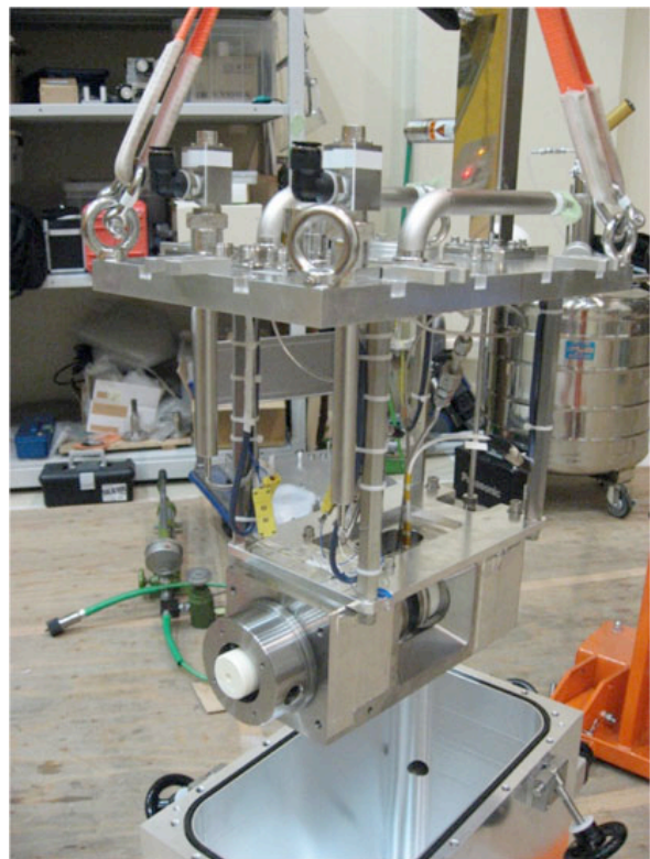
図1. (左) 匠に設置された「中性子散乱実験用温度圧力調整システム」。(右) セルを真空チャンバーに入れるところ。中性子は手前から入射して、90度散乱を測定する。
