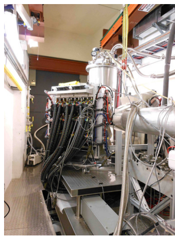
図3. SNAP内に設置された4Kクライオスタット。
