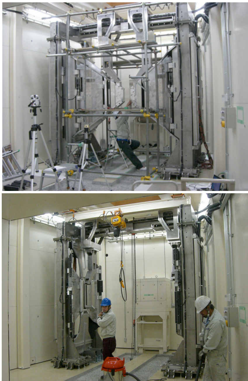
図3 検出器架台：実験モード（上）と退避モード（下）
