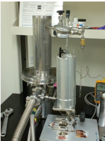
図2. アモルファス氷の生成装置。装置内を真空に引くことで蒸発させたD 2 O(奥のガラス管)およびCO 2 (手前側：徐々に蒸発するよう、150K程度に冷却した)蒸気を、10Kクライオスタットにより冷却させた銅基板に吹き付けることにより、試料を生成する。
