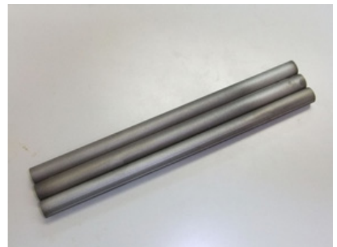
写真1. 熱処理後のTiZr合金の外観。直径は約12mm。
