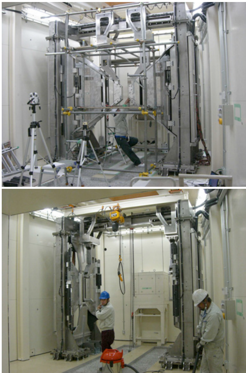
図3 検出器架台：実験モード（上）と退避モード（下）
