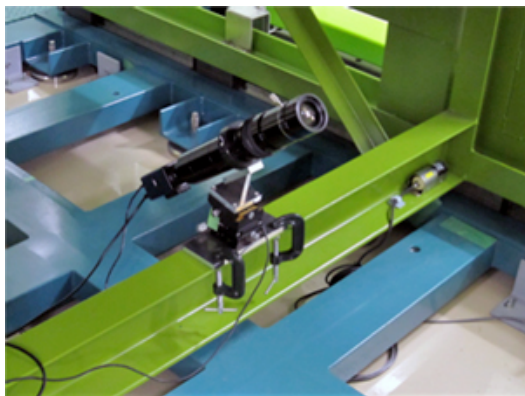
長焦点の望遠カメラ。このカメラを用いてパーム軸方向の位置あわせを行います。
