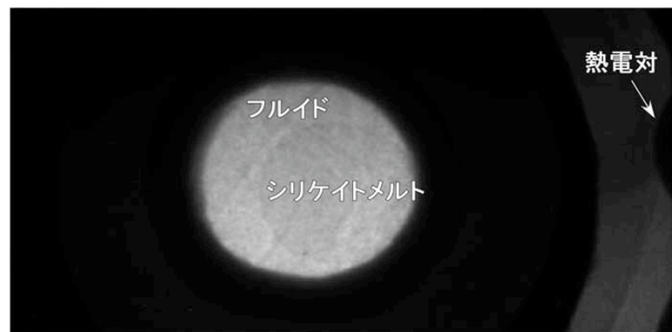
図2. 圧力2.4GPa、温度1180°Cで共存するシリケイトメルトとフルイド。スプリングエイトのエクス線ラジオグラフィによる観察。
