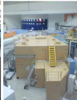
完成したインターロックシステム (赤色信号はシャッターopenのサイン)
