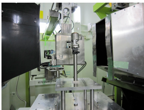
対向型アンビルセルを用いた測定の様子。アンビルにはNPDを用いており、セル中のメタンハイドレートは約1 GPaに加圧されている。
