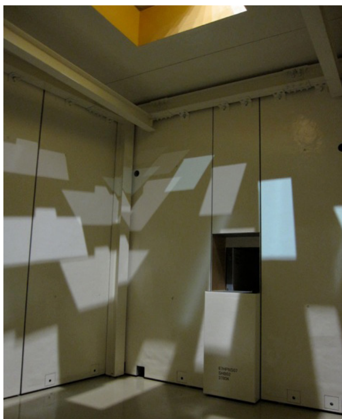
写真の説明 完成したPLANETの実験用ハッチとその内部の様子。内部はまだがらんと、右手に中性子ビームが出てくる窓が見える。ここに6軸高圧プレスが設置される予定。
