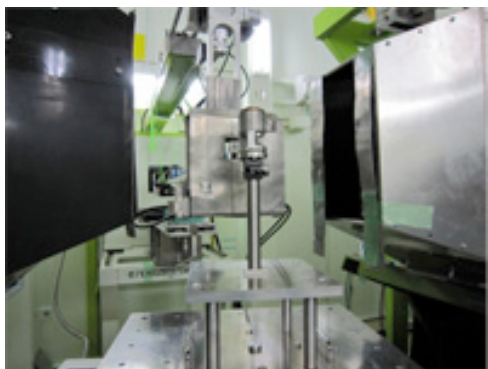
対向型アンビルセルを用いた測定の様子。アンビルにはNPDを用いており、セル中のメタンハイドレートは約1 GPaに加圧されている。
