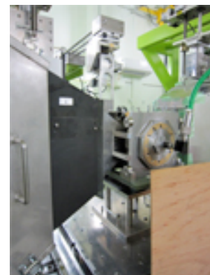
パリエジンバラプレスを用いた測定の様子。パリエジンバラプレス中の \text{Al}_2\text{O}_3 は約2 GPaに加圧されている。
