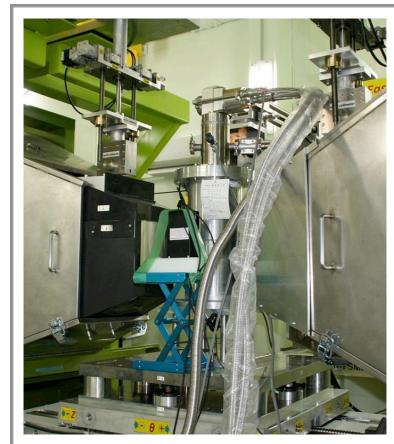
図2. 冷凍機の位置調整の様子。
