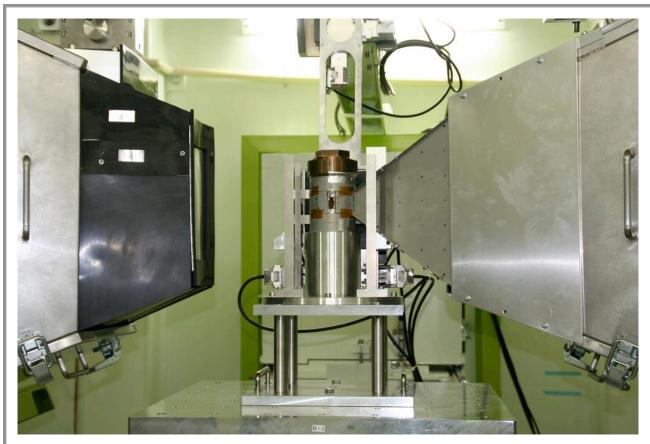
図1. パームキュービック装置を用いた測定の様子。
