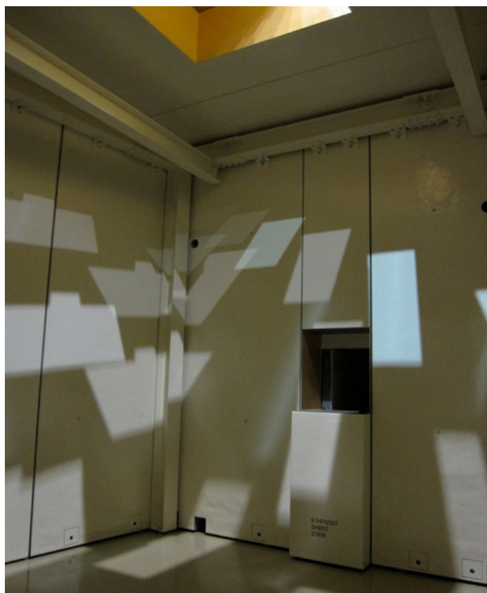
写真の説明 完成したPLANETの実験用ハッチとその内部の様子。内部はまだがらんで、右手に中性子ビームが出てくる窓が見える。ここに6軸高圧プレスが設置される予定。
