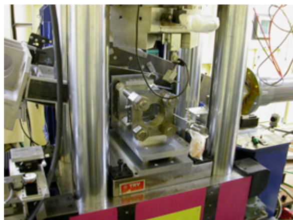
図2 パリエジンバラプレスを横倒しにしたところ
